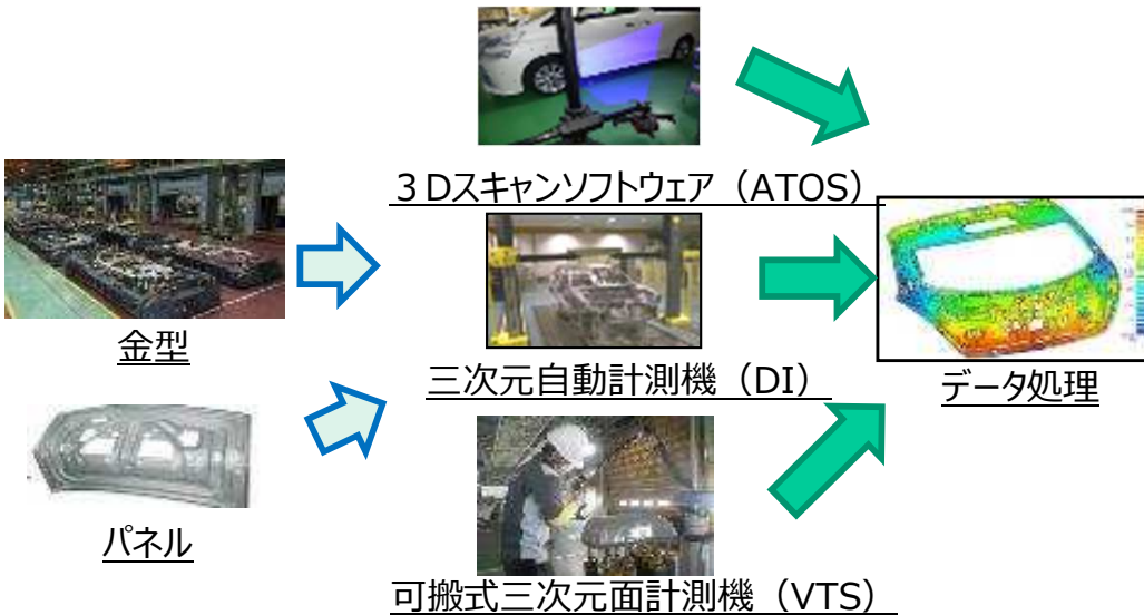
プレスパネル、金型計測(座間事業所、追浜工機工場)
